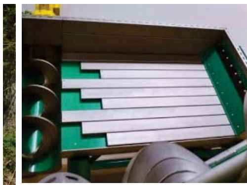
Fond mouvant et spire de transfert de l'incorporateur Huning, photo Winfried Rauch
